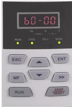
Fig. 4-9 First-tier display of parameter
